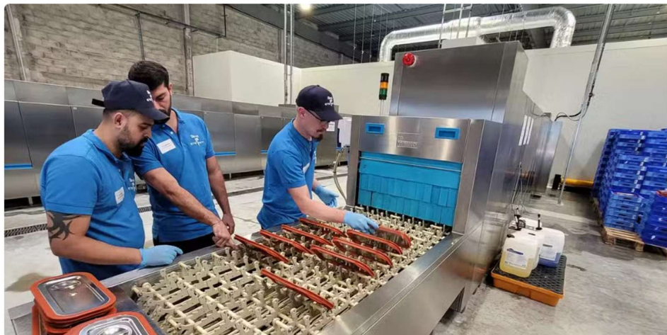
Le site industriel est équipé pour l'instant de deux chaînes de lavage de 14 et 21 m de long. © Crédit photo : O. D.
